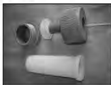
d - Vaso teflón PFA® cubierto con tubo de descarga en donde se inserta la membrana.
